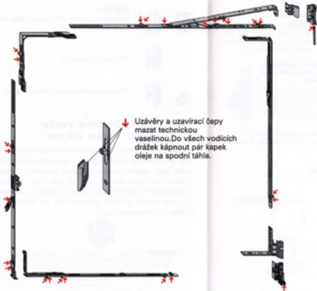
Uzávěry a uzavírací čepy mazat technickou vazelínou. Do všech vodících drážek kápnout pár kapek oleje na spodní táhla.
